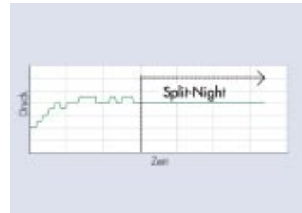
Abb. 6.3: Mit der Option „Split-Night“ wird der Patient im ersten Teil der Nacht titriert und im weiteren Verlauf mit dem empfohlenen Titrationsdruck beatmet
